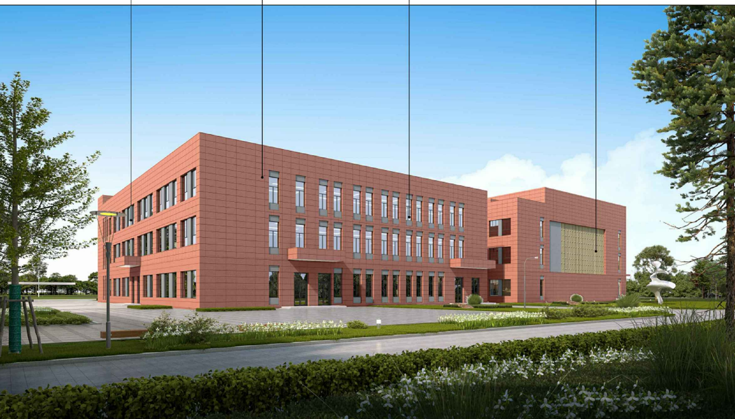
学生活动中心 东北面效果图 灰色干挂陶土板300X600 色卡号0551 千挂红色陶土板 300X600 色卡号0224 黑色铝合金框 无色透明LOW-E玻璃 黄色干挂方管状陶土板 色卡号0073
